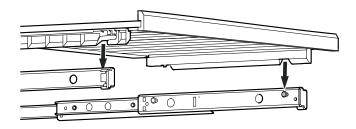
Auszugschienen ganz herausziehen. Das Holzbord mit den vorderen Ausnehmungen auf die Haltebolzen aufsetzen.
